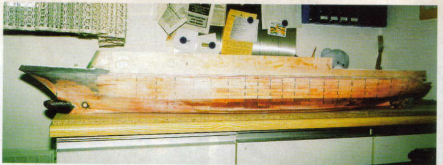
Der fertige Rumpf und das Vorschiff mit übergezogener Strumpfhose.
